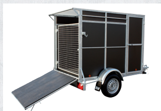
Rampe de chargement + porte intérieur en grill
